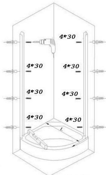
**ВАЖНО!** На все места соединений с полом (поддоном) и стенами нанесите санитарный герметик.
