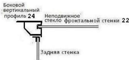
Совместите крепежные отверстия на собранных задних стенах и на каркасе фронтальной стенки, соедините их с помощью саморезов 4\*8 /33/ (рис.5).
