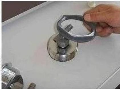
С внутренней стороны к отверстию для форсунки приложите форсунки, с наружной стороны прикрепите форсунки с помощью гайки.
