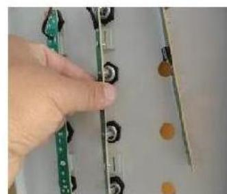
Установите на центральную стойку /7/ декоративные накладки, предварительно установив пластиковые крепежи под верхние и нижние гайки. Вставьте пластины со светодиодами в крепежи.
