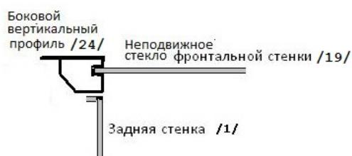
Установите собранный каркас душевой кабины на поддон /13/. Выровняйте на поддоне каркас душевой кабины по переднему бортику, просверлите отверстия на поддоне соответственно отверстиям на нижних профилях задних стенок и соедините каркас душевой кабины с поддоном саморезами 4\*15 /36/, нанесите на места соединений санитарный герметик.
