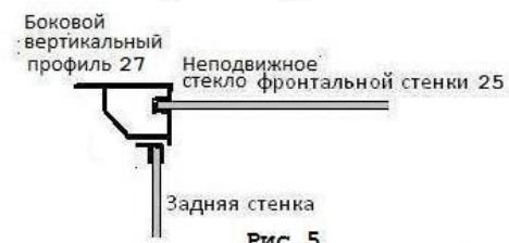
Совместите крепежные отверстия на собранных задних стенках и на каркасе фронтальной стенки, соедините их с помощью саморезов 4\*8 /36/ (рис.5).
